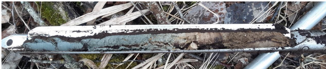
Foto 5.4. Kohati esineb turba lamamis järvemuda ja selle all sinakashall liivsavi. Vão VIII sondeerimispunkt S-9, int 1,6 - 2,1 m.
